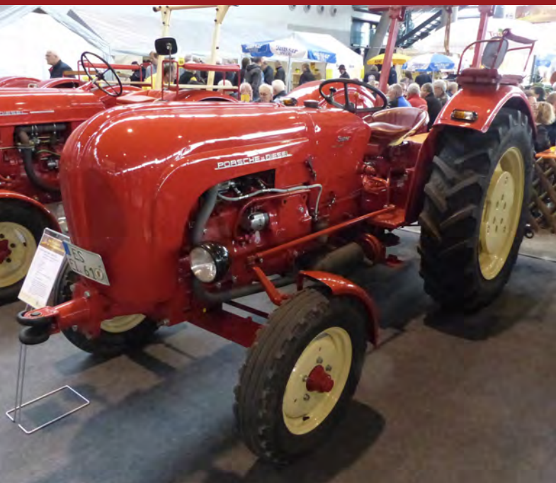
Der Super Export 329 war der letzte Dreizylinder den Porsche-Diesel auf dem Markt brachte. Der Porsche-Motor F 329 leistete 35 PS. Das Getriebe T25 (8V/2) stammte von Deutz und erlaubte eine maximale Geschwindigkeit von 30 km/h.
