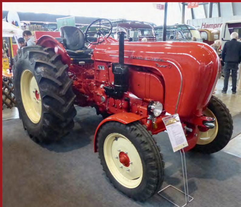
Die Muschelkotflügel an diesem Master 429 V lassen eine Export-Version vermuten. Sein Motor war identisch mit dem des 408 N, das 5-Gang-Getriebe (5V/1R) konnte bei ZF auch mit einem Kriechgang geordert werden.
