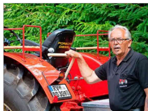
Von Hinterzarten ging es über über Bärenental nach Todtnau. Klaus Strohm aus Schleswig Holstein (rechts) erklärt den Hydrostopp. Kupplung und Gas können so von außerhalb bedient werden.
